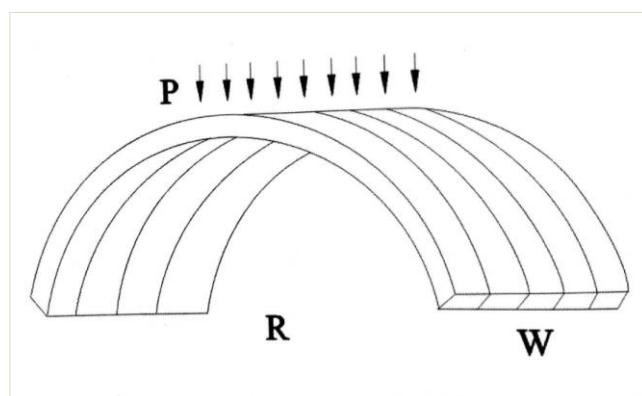
3. 最小弯曲半径=板材厚度×175 倍, 该值为极限弯曲半径, 非保证值。为避免暴露在外的那面发生破裂, 阳光板的弯曲半径不得小于下表所列参数标准。
